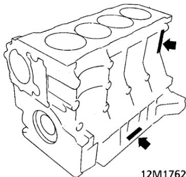
发动机号印在轴承阶梯的左侧或浇铸在气缸盖后部的左侧。
